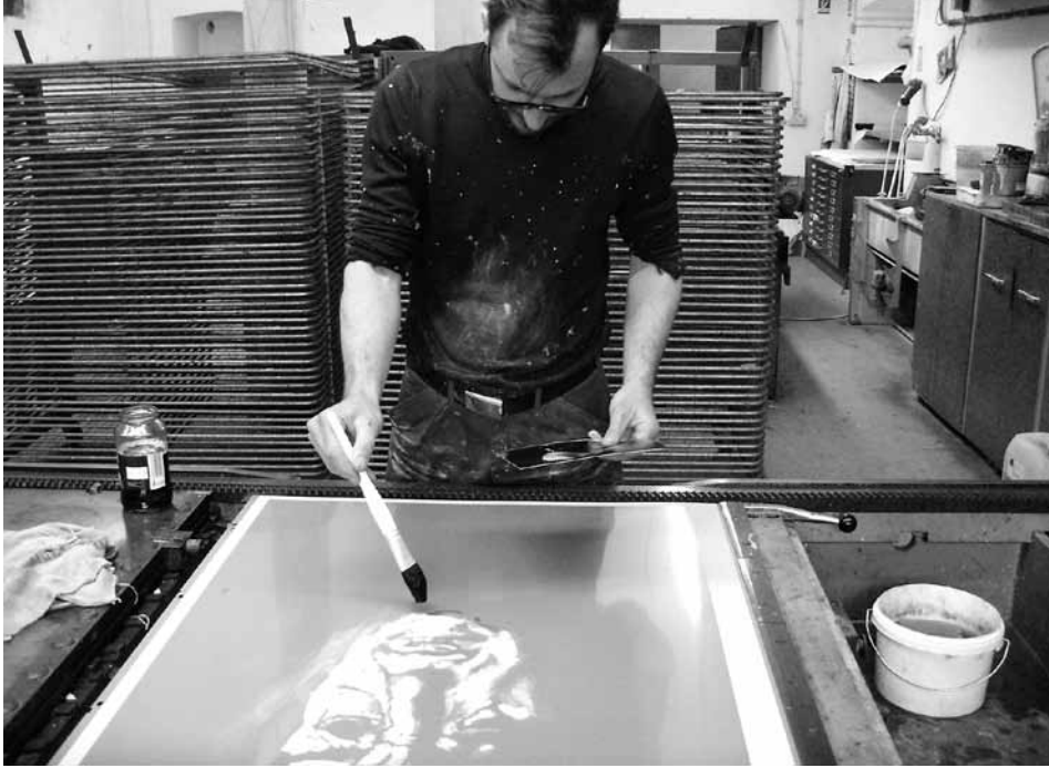
DENNIS RUDOLPH MALT MIT KORREKTURLÖSUNG AUF EINER BELICHTETEN OFFSETPLATTE IN DER DRUCKWERKSTATT 2011
